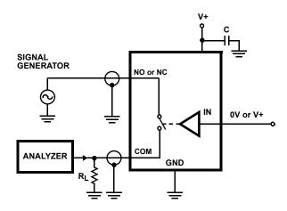
FIGURE 4. OFF ISOLATION TEST CIRCUIT
