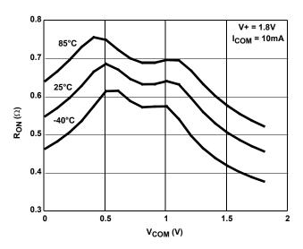
FIGURE 13. ON RESISTANCE vs SWITCH VOLTAGE
