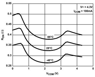
FIGURE 11. ON RESISTANCE vs SWITCH VOLTAGE
