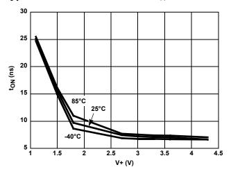
FIGURE 15. TURN-ON TIME vs SUPPLY VOLTAGE
