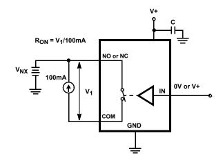
FIGURE 5. R<sub>ON</sub> TEST CIRCUIT
