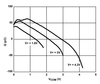
FIGURE 14. CHARGE INJECTION vs SWITCH VOLTAGE
