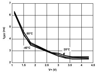
FIGURE 16. TURN-OFF TIME vs SUPPLY VOLTAGE
