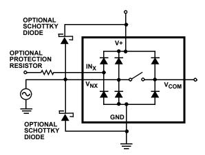
FIGURE 8. OVERVOLTAGE PROTECTION
