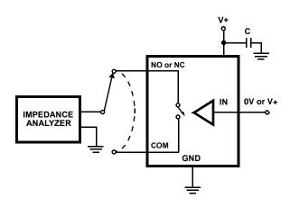
FIGURE 7. CAPACITANCE TEST CIRCUIT
