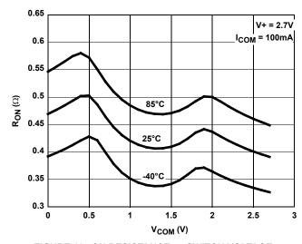
FIGURE 12. ON RESISTANCE vs SWITCH VOLTAGE
