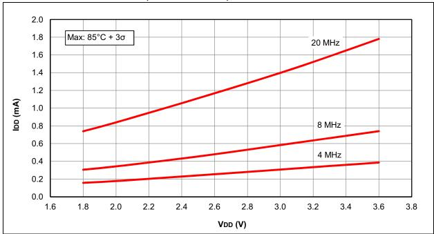
FIGURE 26-29: IDD TYPICAL, HS OSCILLATOR, PIC16F1516/7/8/9 ONLY
