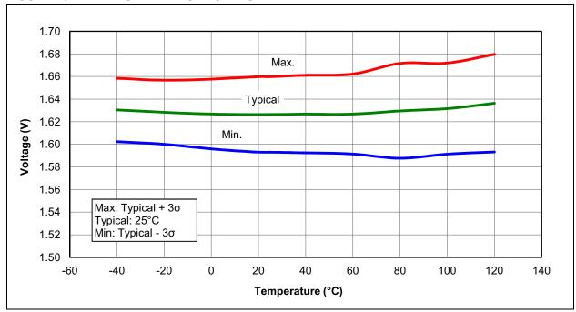
FIGURE 26-48: POR REARM VOLTAGE, PIC16F1516/7/8/9 ONLY
