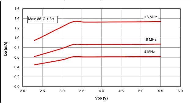
FIGURE 26-27: IDD TYPICAL, HS OSCILLATOR, PIC16LF1516/7/8/9 ONLY
