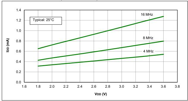
FIGURE 26-24: IDD MAXIMUM, HFINTOSC MODE, PIC16LF1516/7/8/9 ONLY
