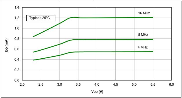
FIGURE 26-26: IDD MAXIMUM, HFINTOSC MODE, PIC16F1516/7/8/9 ONLY
