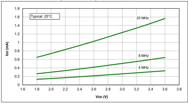
FIGURE 26-28: IDD MAXIMUM, HS OSCILLATOR, PIC16LF1516/7/8/9 ONLY
