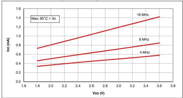
FIGURE 26-25: IDD TYPICAL, HFINTOSC MODE, PIC16F1516/7/8/9 ONLY
