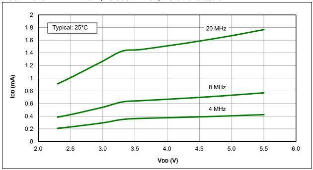
FIGURE 26-30: IDD MAXIMUM, HS OSCILLATOR, PIC16F1516/7/8/9 ONLY
