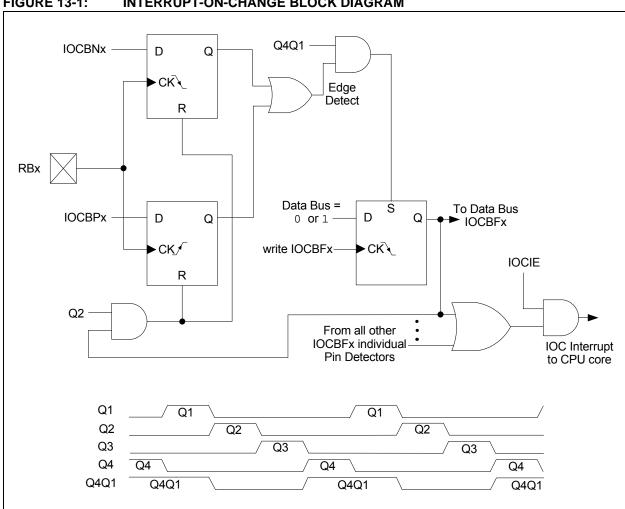
**FIGURE 13-1:** INTERRUPT-ON-CHANGE BLOCK DIAGRAM
