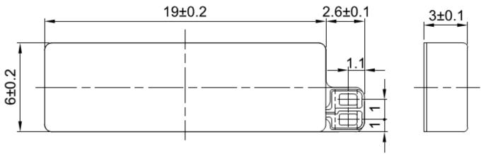
默认的连接形式为100mm长AWG30导线(剥头8.5mm),可根据客户要求换成连接器、电极弹簧等其它连接形式。
