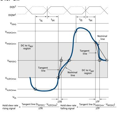
Note: 1. DQS, DQS# signals must be monotonic between V<sub>IL(DC)max</sub> and V<sub>IH(DC)min</sub>.
