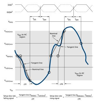
Note: 1. DQS, DQS# signals must be monotonic between V<sub>IL(DC)max</sub> and V<sub>IH(DC)min</sub>.
